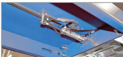
Verrouillage pneumatique au centre de la plaque coulissante
